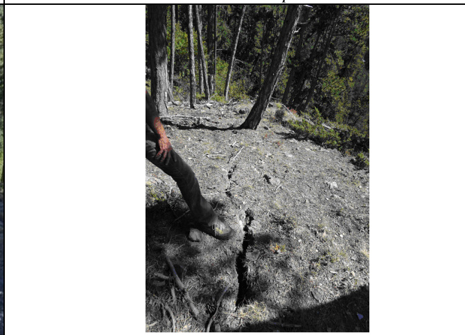
Fissures ouvertes de 20 à 40cm et profondes de plus de 10m en arrière et en parallèle au rebord de la marge Est depuis le levé de points GPS (19 août 2013)
